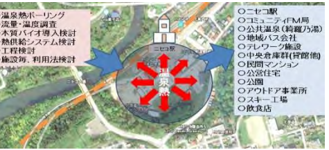
地域資源を活用した地域熱供給(ニセコ駅前)
