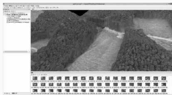
ドローンの空撮データから作成した3次元画像
