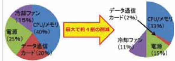
光配線への置き換えによるサーバの消費電力削減効果
