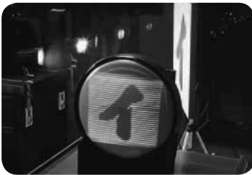
世界初の電子式テレビ(写真は再現装置によるもの)
